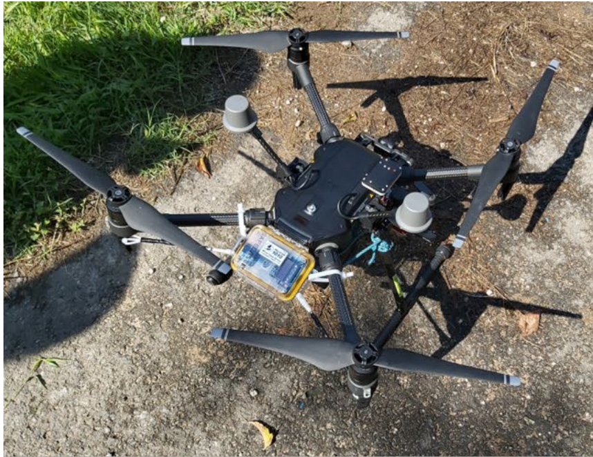
DJI Matrice 210 V2 RTK UAS
